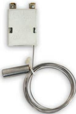
Der Maximaltemperaturbegrenzer KRU ist ein mechanischer Kapillarrohrfühler zur Begrenzung von Fußbodentemperaturen für die Speicher- und Ergänzungsheizung oder auch unter Laminatfußböden. Der KRU eignet sich zum Einbau in eine UP-Dose 100 | 100.
