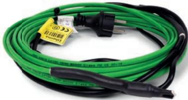
ETHERMA ICESTOP schützt Rohre vor Eis und in weiterer Folge vor Schäden. ICESTOP ist ein steckerfertiges Heizkabel mit einer konstanten Leistung von ca. 10 W/m. Das Thermostat ist zu 100 % feuchtigkeitsgeschützt und schaltet den Frostschutz bei Temperaturen unter + 3 °C ein und ab + 9 °C wieder aus.
