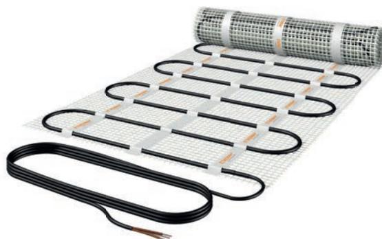
Die Freiflächenheizung GSN zum Einbau in Gussasphalt dient der Schnee- und Eisfreiheit von Parkgaragen-Einfahrtsrampen, Rettungszufahrten, Eingangsbereichen, etc. Die Heizmatte GSN besteht aus einem Glasseiden-Panzergeflecht auf dem ein Dipolheizleiter aufgeklebt ist. Die erlaubte Aufbringungstemperatur beträgt 240 °C für 35 min.
