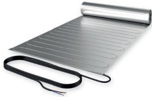
Laminotherm Heizmatten werden zur Temperierung und Beheizung von Räumen mit Parkett- und Laminatböden verwendet. Das Heizsystem wird ausschließlich schwimmend verlegt. Zum Schutz der Heizmatten sollte Laminotherm nur in Kombination mit Laminoflies eingebaut werden. Die Trittschalldämmung ETHERMA Laminoflies garantiert einen optimalen Einbau und die perfekte Wärmeverteilung der Laminotherm Heizmatte.
