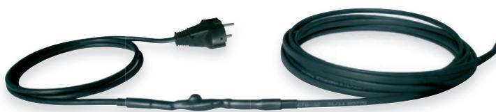
ETHERMA ICESTOP TRACE schützt Rohre vor Eis und in weiterer Folge vor Schäden. Es ist ein steckerfertiges selbstregulierendes Heizband mit einer Leistung von 15 W/m bei + 5 °C.
