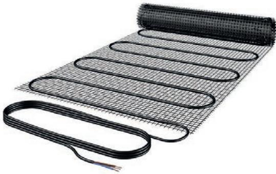
Die Heizmatte DSN besteht aus einem Glasseidennetz auf dem ein Heizleiter mit UV-beständiger Außenisolierung aufgenäht ist (für Folien- und Blechdächer). Sie dient als Sicherheitsmaßnahme gegen Beschädigung durch Schneelasten an Dächern, Dachrinnen und Gebäuden.
