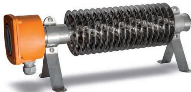
Zur Beheizung von feuchten Räumen, wie z.B. Gewächshäusern, Schutz empfindlicher Anlagen vor Frost, Heizung in rauen Betriebsumgebungen, wie z.B. Pumpstationen, Krankkabinen, Bauwagen und Meisterbüros in Werkshallen. Der eingebaute Heizeinsatz aus Keramik sorgt für eine gute Wärmeverteilung. Robuster rostfreier Heizkörper aus Edelstahl, Werkstoff 1.4512; alle Montagestellen staub- und wasserdicht; für Boden- und waagrechte Wandmontage geeignet.
