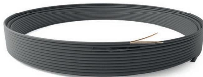
Die Heizschleife BRLH eignet sich zur freien Verlegung speziell bei Rundungen, Kurven und dort, wo die Verlegegeometrie es erfordert. Die Verlegung kann in Gussasphalt, Walzasphalt, Fließbeton, Monolithbeton, Ortsbeton, Sand- und Mörtelbett sowie unter Kopfsteinpflaster erfolgen. Der Dipolheizleiter hat eine sehr robuste, schlagfeste Außenisolierung und trotz dadurch erhöhten mechanischen Belastungen.
