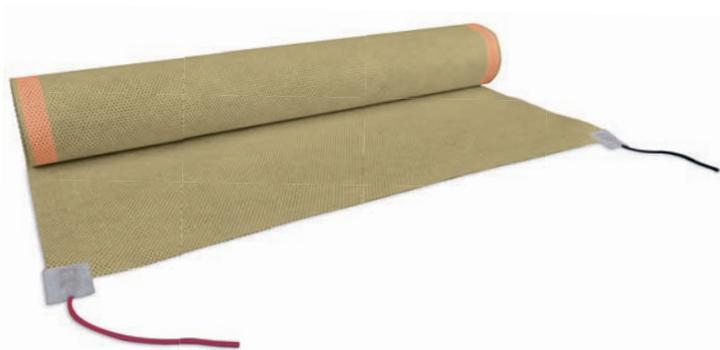
ETHERMA eFOIL ist eine diffusionsoffene, vlieskaschierte und haftungsoptimierte Heizfolie zum Wand- oder Deckeneinbau in Spachtelmassen, Feinputz oder Fliesenkleber. Durch ihre äußerst geringe Stärke von nur 0,4 mm ermöglicht sie eine sehr niedrige Aufbauhöhe. Die Folie dient sowohl zur Beheizung von Räumen als auch zur Kälteabschottung an Wänden.
