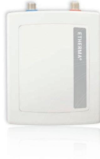
Der hydraulisch gesteuerte Durchlauferhitzer ETHERMA AQUA WHM in druckfester Ausführung ist für die schnelle Warmwasseraufbereitung bei begrenztem Wasservolumen von Waschbecken geeignet. Der eingebaute Differenzdruckschalter ermöglicht ein Einschalten schon ab 1,2 bar und einer Wasserdurchflussmenge ab 1,2 l/min. Er schaltet das Gerät automatisch in den Heizbetrieb.
