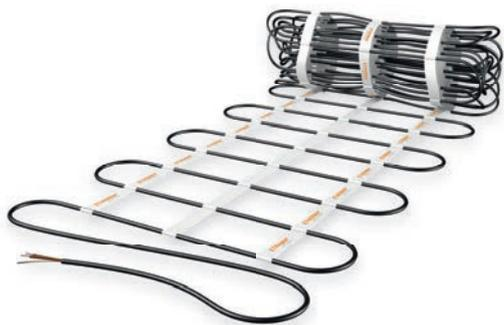
Die Freiflächenheizung BRS zum Einbau in Beton und Walzasphalt dient der Schnee- und Eisfreiheit von Parkgaragen-Zufahrtsrampen, Rettungszufahrten, Eingangsbereichen, etc. Die Heizmatten werden auf eine tragfähige Unterschicht (Beton oder Asphalt) gemäß Verlegeplan ausgelegt.
